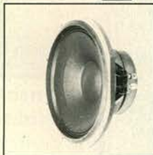
BGS 30 NG: 12"-basluidspreker van topkwaliteit. Zeer hoog belastbaar. Voor discotheken, orgels, keyboards en P.A. Geschikt voor hoornconstructies en basreflexboxen. 200/300 watt, gemiddelde geluidsdruk 97 dB, 8 en 16 Ω.
